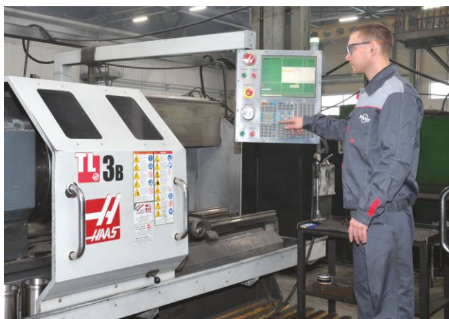
Токарная обработка гильзы на станках HAAS (США)
