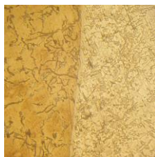
Микроструктура: соединение нирезистой вставки с алюминиевым сплавом.
