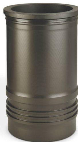
Мокрая фосфатированная гильза (КМЗ 7511-1002021-01-70)
